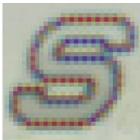
Viditelné artefakty běžné bilineární interpolace Bayerovy masky
